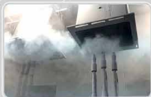
▲ سامانه خودکار پاشش لعاب الکترواستاتیک ویژه فر توکار یکپارچه (Cavity)
