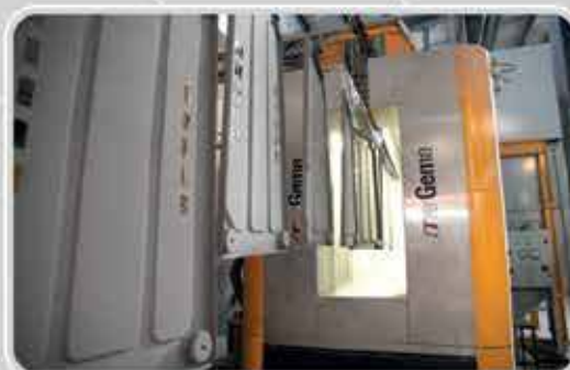
▲ سامانه خودکار پاشش لعاب الکترواستاتیک Gema
